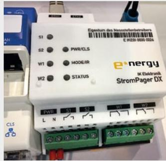
führt die Integration in das Smart Grid fort und besitzt einen Rückkanal über die CLS Schnittstelle. Durch diese ist der Weg zur Integration in das Smart Grid und zu einer vollwertigen FNN-Steuerbox für den Strompager frei. Die funkbasierte Stromnetz-Steuerung durch e\*Nergy leistet damit einen wertvollen Beitrag zur Energiewende.
